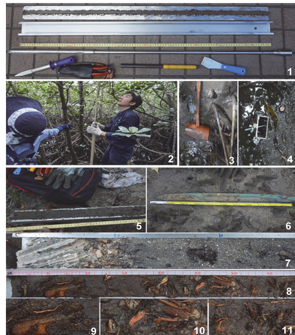
図5 GeoslicerNM5一式と作業状況概要
